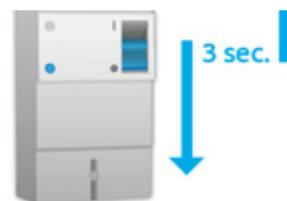
Positionnez le disjoncteur en position **O**, attendez 3 secondes et remettez le disjoncteur en position **I**.
